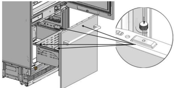
Снимите дверцу морозильного отделения отвинтив два шурупа в передней части направляющих.
