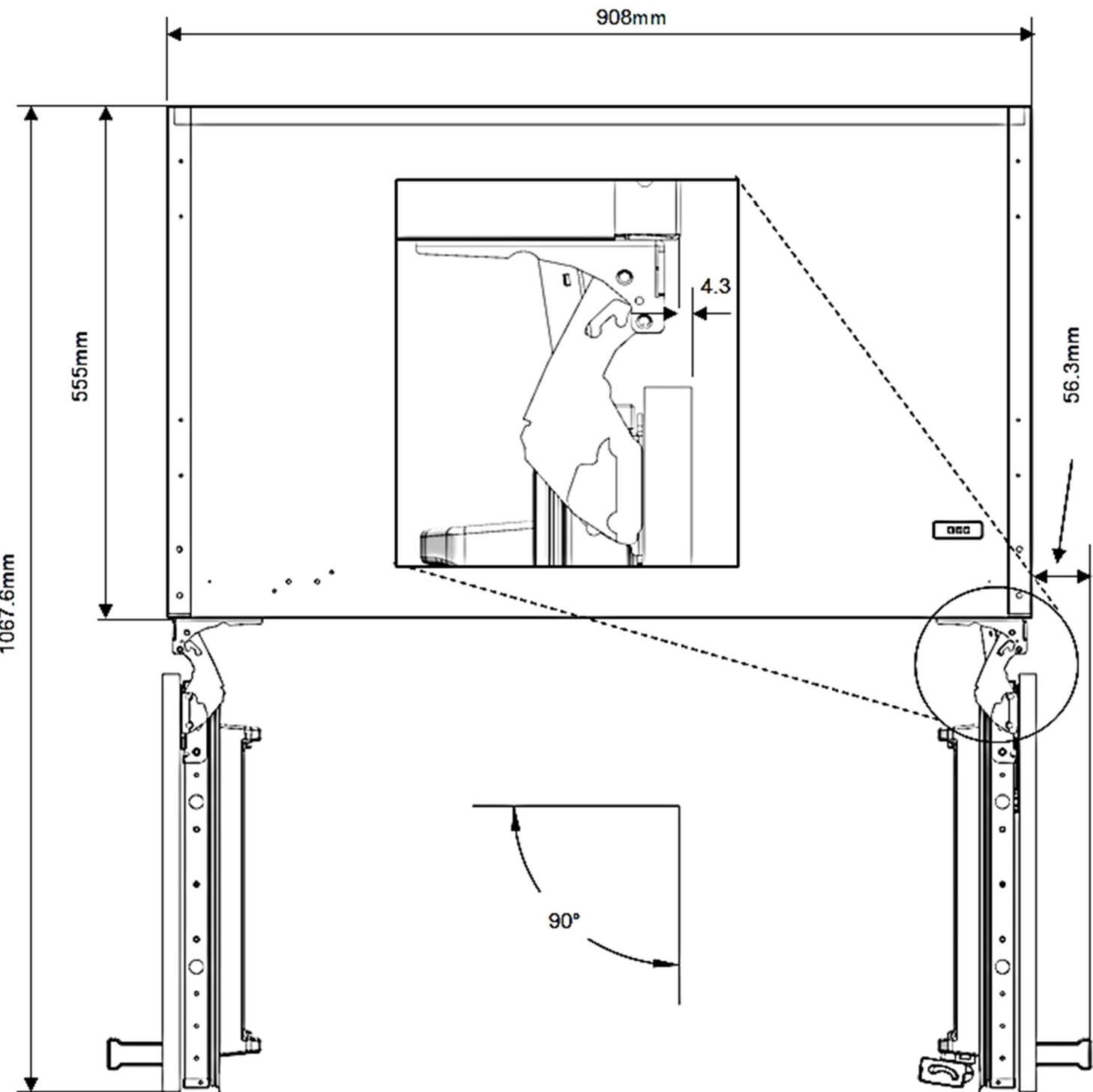
**УСТАНОВКА ПРИБОРА****РАЗМЕРЫ ДЛЯ МОНТАЖА**
