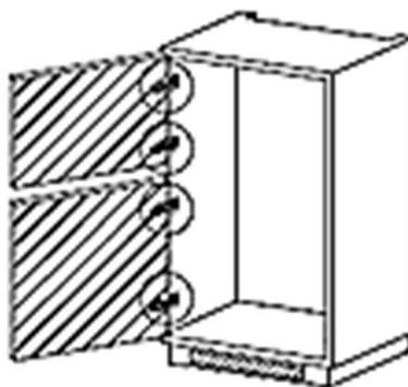
2. Установите изделие в шкаф. При установке необходимо оставить зазор в 3-5 мм между стенкой шкафа и корпусом холодильника со стороны, где петли не установлены.
