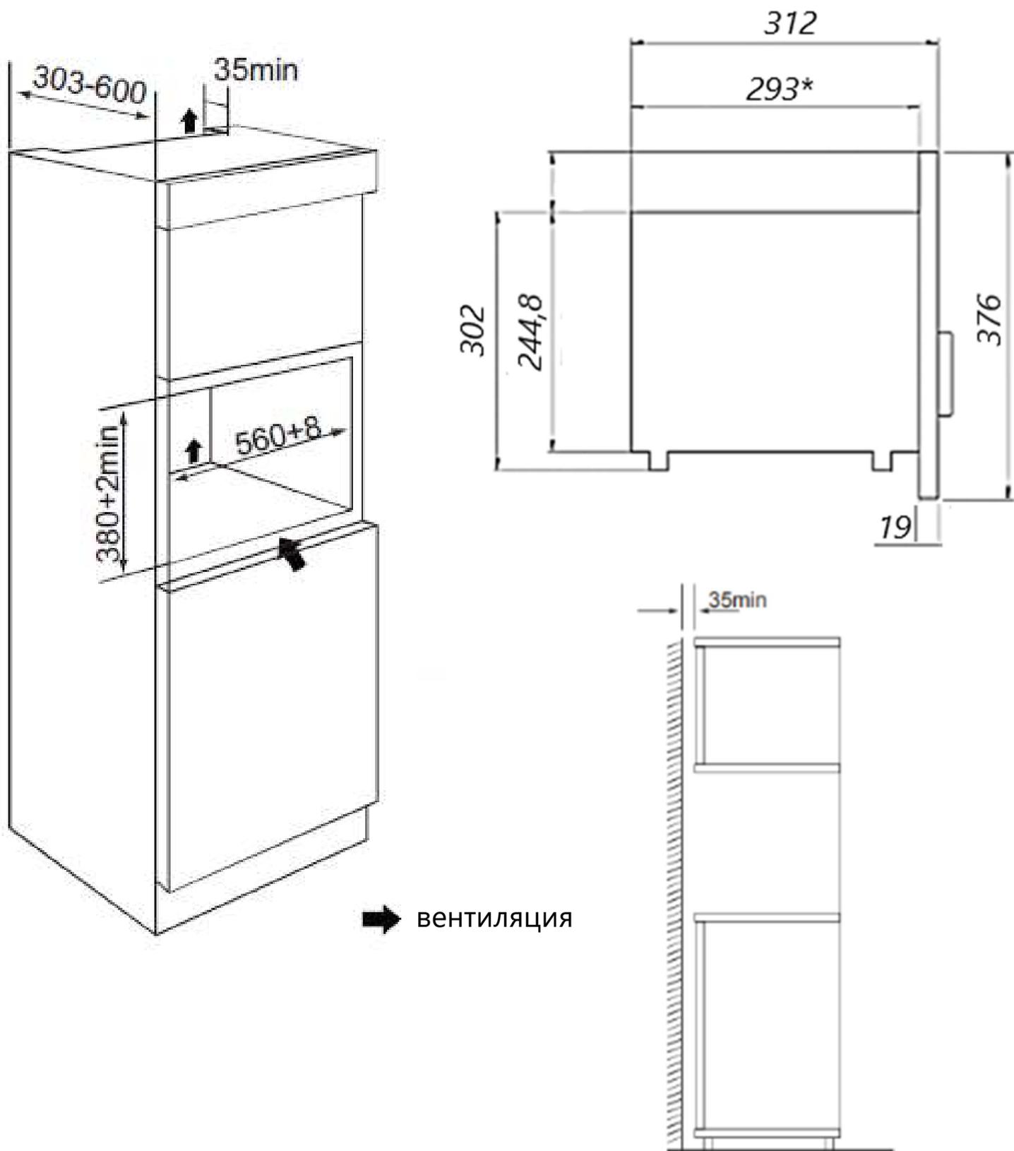
\* - глубина СВЧ-печи без учета наконечника кабеля, предохраняющего кабель от излома.
