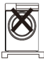
Установка на кронштейн
