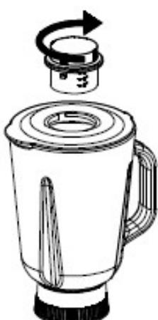
4. Вставьте мерный колпачок в крышку блендера и поверните по часовой стрелке до фиксации.
