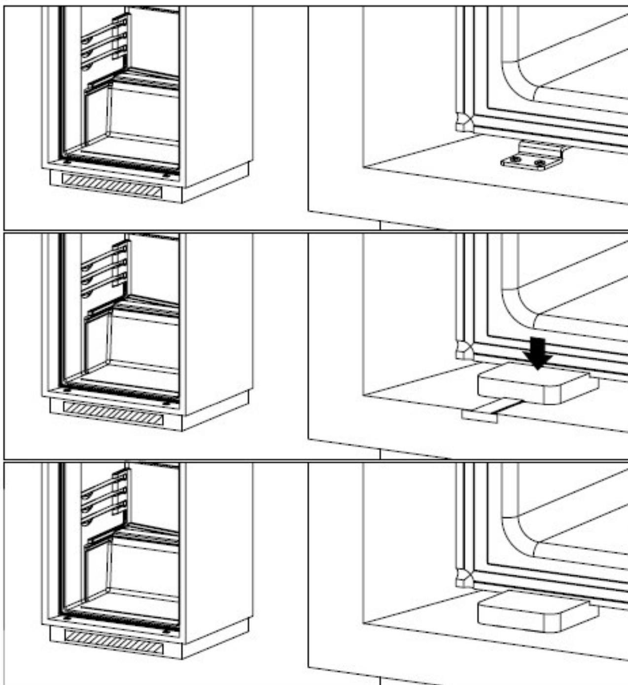
4. Используйте прокладку для того чтобы закрыть зазор.
