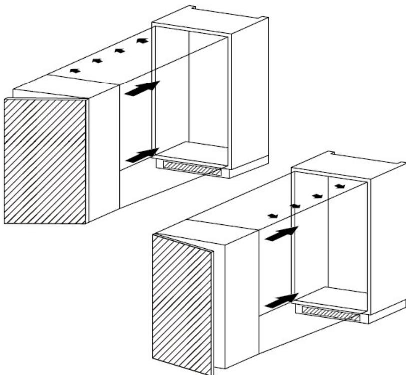
**3.** В основании прибора находятся две металлические пластины. Установите прилагаемые белые прокладки на эти пластины на основе следующих фотографий. Убедитесь, что выступы прокладок находятся на одном уровне с выступом основания шкафа. Как правило, чем больше воздуха может попасть внутрь и наружу, тем лучше и эффективнее работает изделие.
