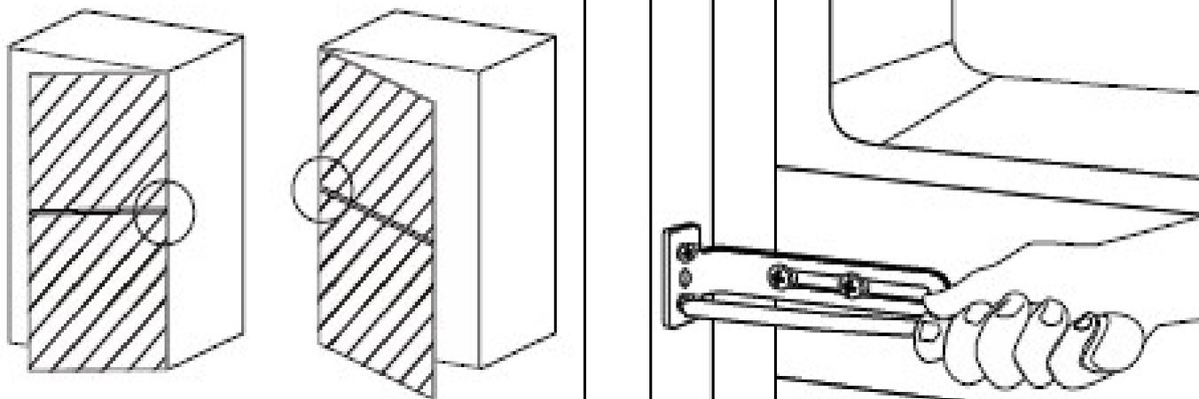
6. Установите слайдерную прокладку и закройте крышкой. Затем установите соединительный кронштейн в деревянную доску и изделие.
