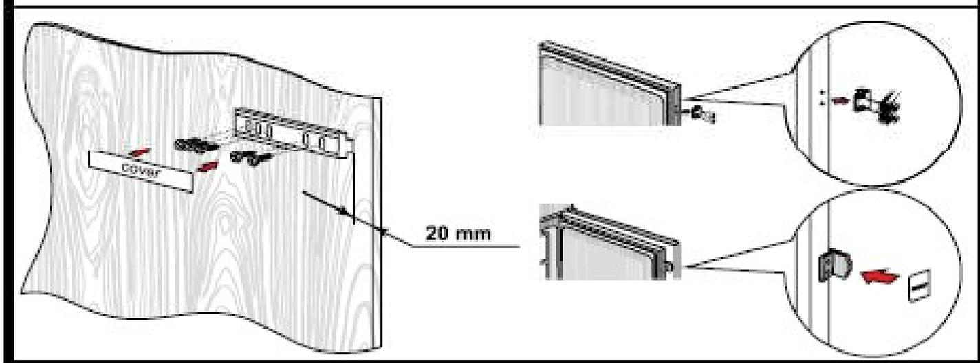
7. Установите крышку петли в следующем положении.
