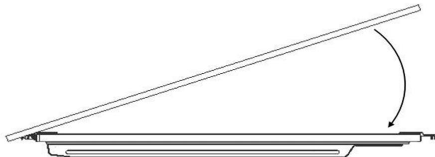
Используйте винты снятые при демонтаже заглушек дверцы, чтобы прикрепить верхнюю часть декоративной панели к дверце холодильного отделения.
