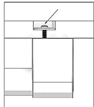
Установите крепежную сборку на декоративную панель дверцы морозильного отделения с помощью винтов. Затем закрепите три металлические скобы винтами (см. Рис). При креплении ручки двери, убедитесь, что части винтов, держащих ручку, не возвышаются над плоскостью декоративной панели.
