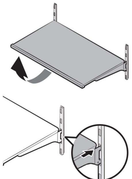
Обратите внимание, что дверцы прибора не смогут закрыться, если дверные полки и внутренние полки отделений установлены на одном и том же уровне. После перестановки полок убедитесь, что дверцы прибора плотно закрываются.
